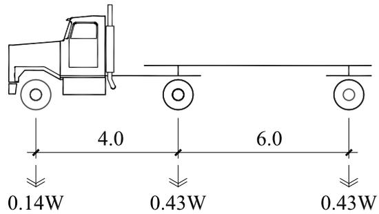
FIGURE 6.1.2 CS2 Load Evaluation Truck
