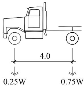
FIGURE 6.1.3 CS1 Load Evaluation Truck
