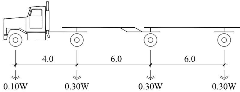
FIGURE 6.1.1 CS3 Load Evaluation Truck
